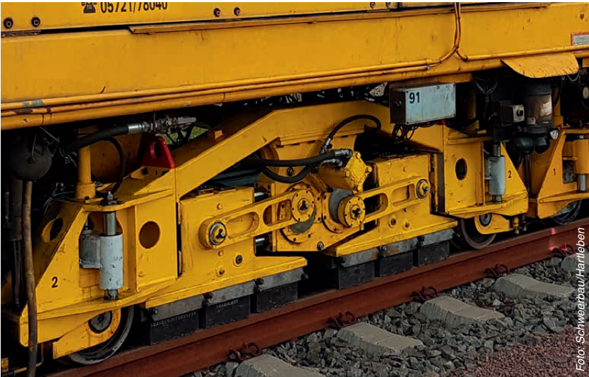
Abbildungen 4 und 5: Schleifaggregat der GWM 550 und technische Parameter GWM 550
