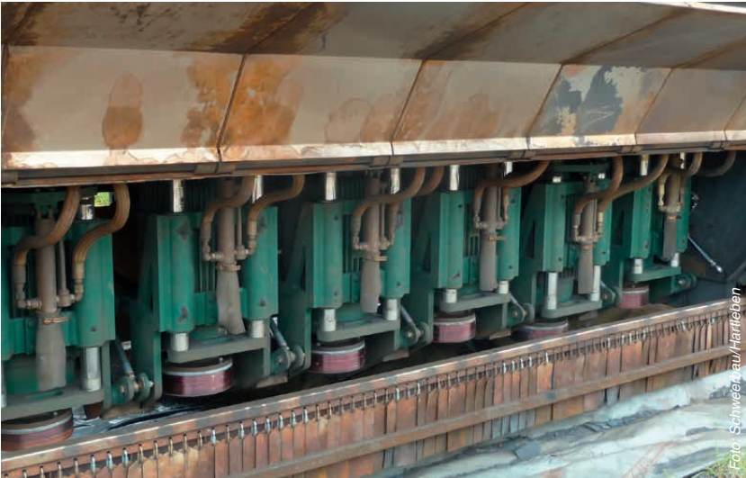
Abbildungen 2 und 3: Geöffnetes Schleifag- gregat der RG48 und technische Parameter Schienenschleif- maschine RG48
