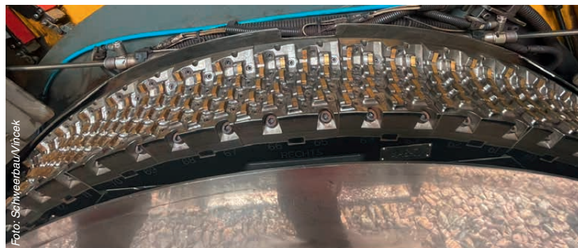
Abbildungen 6 und 7: Technische Parameter Fräsmaschine HSM und geöffnetes Fräsaggregat der HSM
