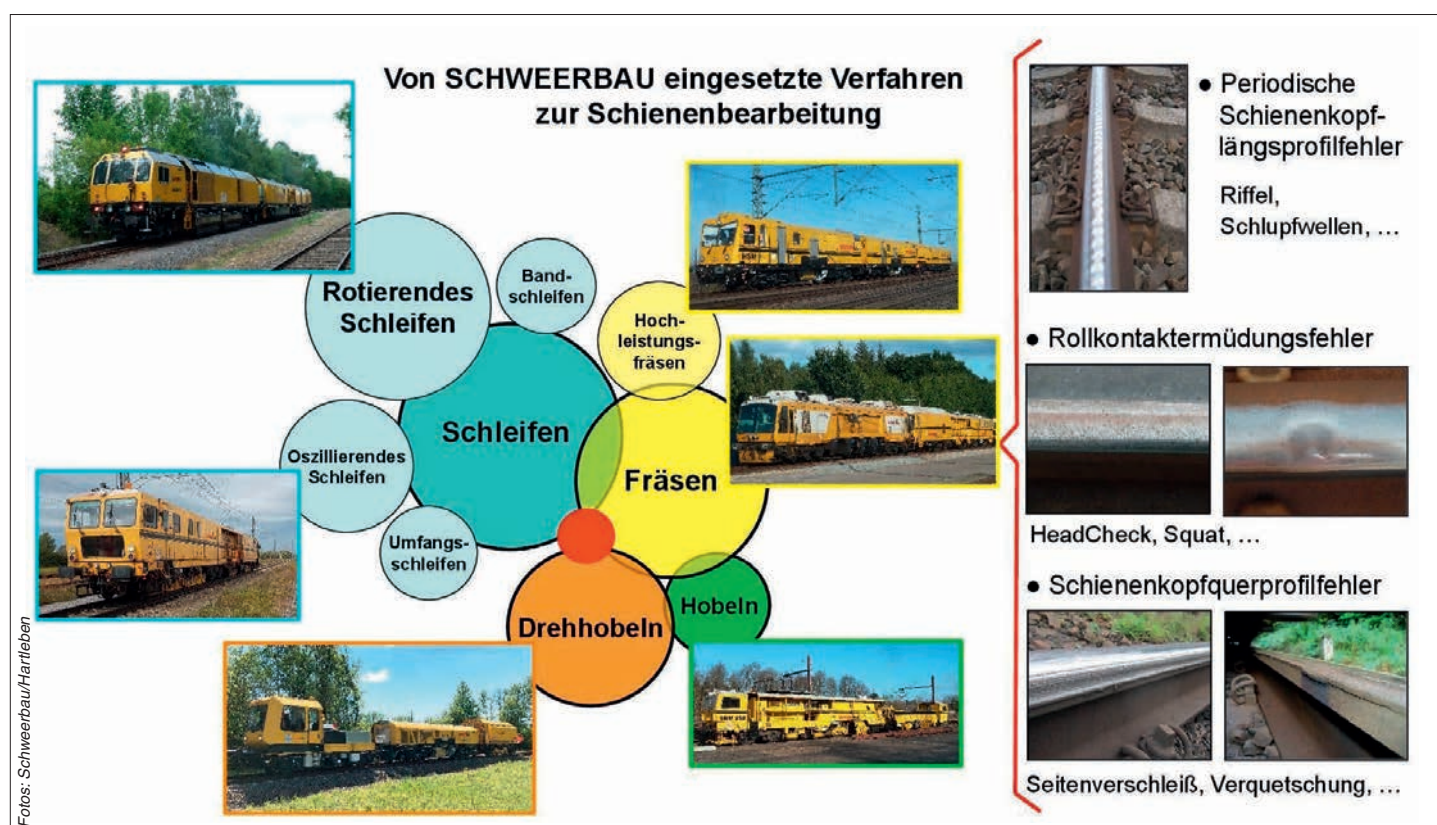
Abbildung 1: Typische Schienenfahrflächenfehler, Bearbeitungsverfahren, eingesetzte Maschinen
