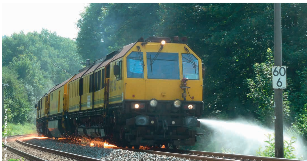
Abbildung 12: TPG Schleifen mit RG48
