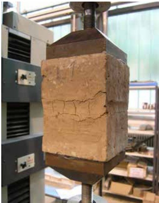
Bild 21: Versuchsaufbau zur Bestimmung der Haftzugfestigkeit von Lehmmauerwerk
