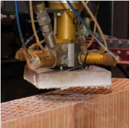
Bild 1: Aufbringen des Klebers. Quelle: Schlagmann Poroton, Redbloc
