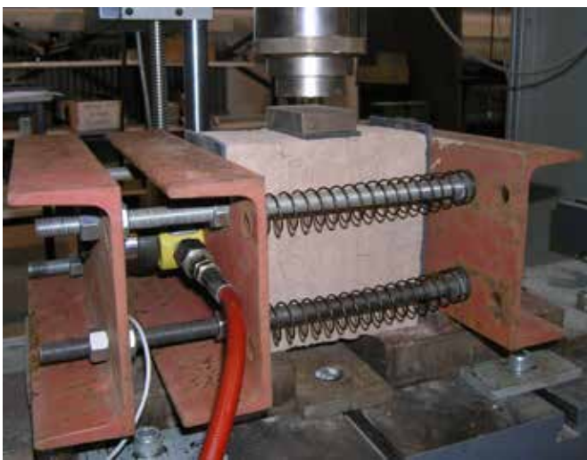
Bild 15: Versuchsaufbau zur Bestimmung der Scherfestigkeit von Lehmmauerwerk
