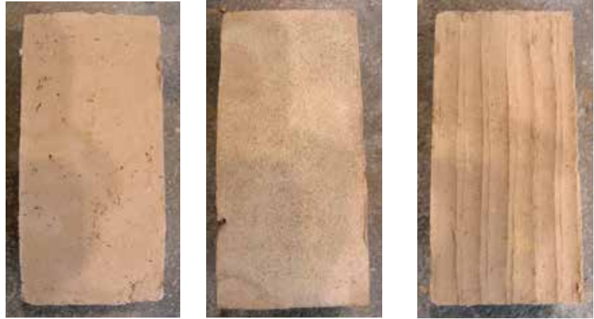
Bild 16: Handgefertigte Lehmsteine mit den Oberflächenbeschaffenheiten (v.l.n.r.) 'Glatt', 'Besandet' und 'Handstrich'
