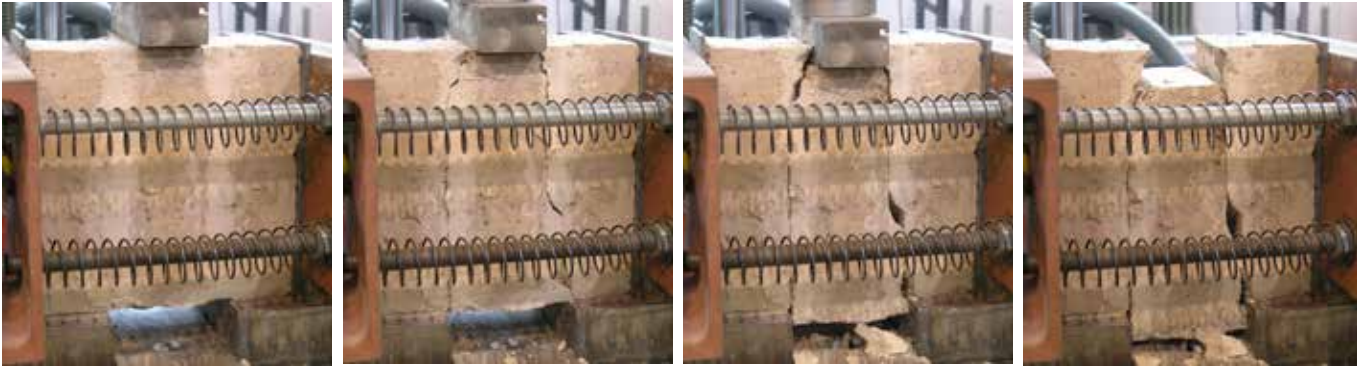
Bild 19: Scherversagen von Mauerwerk mit Lehmsteinen unterschiedlicher Oberflächenstruktur bzw. mit unterschiedlichen Mörtelzusammensetzungen
