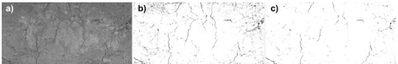
Bild 7: Rissbilder des Abdichtungsmaterials der Deponie B am Ende des fünften Austrocknungszyklus: a) gewählter Bildausschnitt b) Graustufenbild mit Grauwerten unterhalb Schwellenwert S_1 und c) Schwarz-weiß-Bild mit reduziertem Bildrauschen
